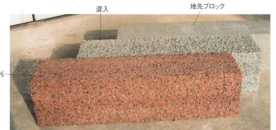
廃ガラス80% 地先ブロックの試作
