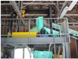
④ 一次破碎機 ガラスびんを破碎します。
