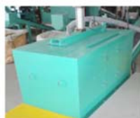
⑱スパイラル破碎機 薄型パネルやソーラーパネルをそのまま投入し破碎します。
