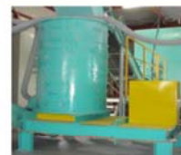
㉖ワイドクラッシャー 粗破碎後の製品を攪拌し素材ごとに分離します。
