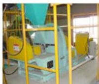
㉑スーパーミル 破碎後のガラスのエッジレス加工(角取り)を行います。
